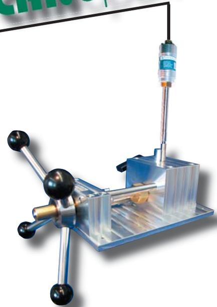
Schmelzdruckfühler bieten in der Regel nur 2 definierte Punkte die als elektrische Kalibrierreferenz genommen werden können - den Nullpunkt und den 80%-Wert. Da die Aufnehmer einer gewissen Temperaturbeeinflussung unterliegen ist der Nullpunkt oft ungleich Null. Dieser lässt sich aber elektronisch relativ einfach ausgleichen. Der 80% Wert wird im Aufnehmer elektrisch simuliert. Da es lediglich eine elektrische Simulation ist muss der echte 80% Druckwert nicht identisch sein.
