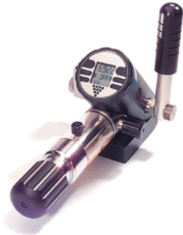
Masse- oder Schmelzedrucksensoren sind mit Flüssigkeit gefüllte Druckmittlersysteme. Bei starker Beanspruchung kann das gefüllte System undicht werden. Dies äußert sich jedoch nicht durch einen sofortigen Ausfall des Fühlers, sondern erfolgt schleichend, d. h. der angezeigte Wert entspricht nicht mehr dem wahren Druckwert. Deshalb müssen Messgeräte nach ISO jährlich überprüft werden. Masse- / Schmelzedrucksensoren sind Messgeräte.
